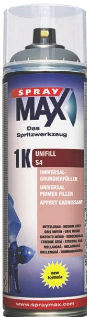
**ITALIANO** Fondo isolante riempitivo ad essiccazione veloce per la protezione dalla corrosione. Può essere applicato direttamente su acciaio, acciaio zincato e diverse materie plastiche. Non adatto per superfici in alluminio, polistirolo, PP, PE, PP/EPDM.
